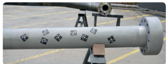
Rohr mit AICON Messmarken
